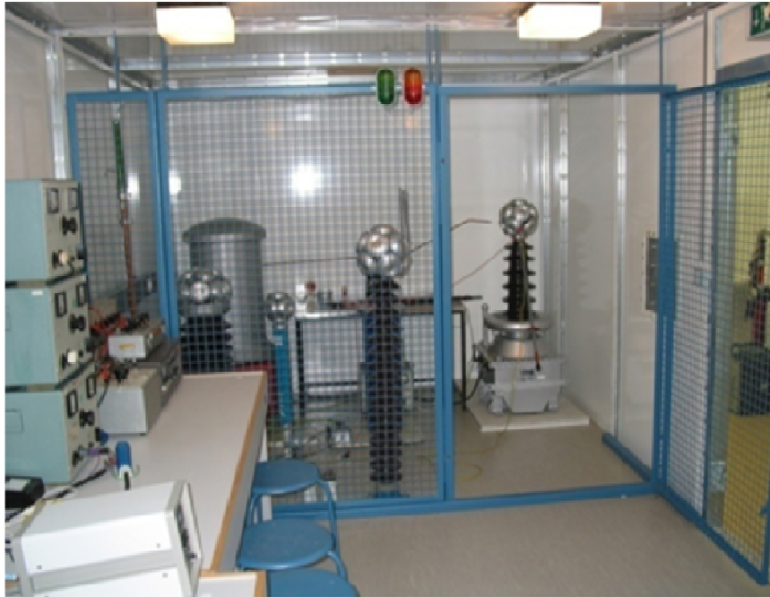
Abbildung: Geschirmte Messkabine zur Teilentladungs- und Verlustfaktormessung
